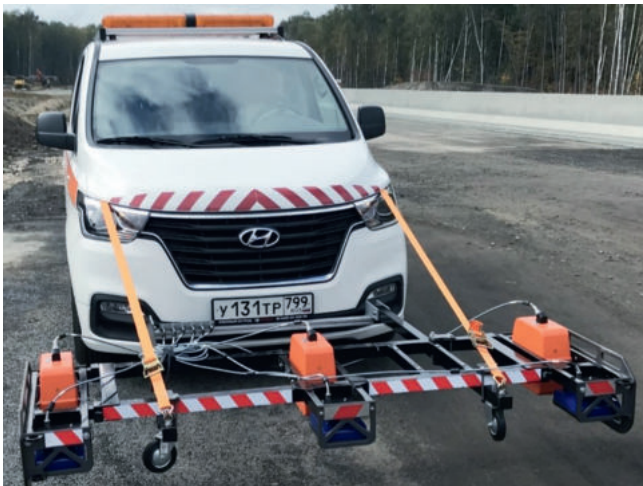
Рис. 3. Мобильная дорожная лаборатория ФАУ «РОСДОРНИИ» с шестиканальным георадарным комплексом
