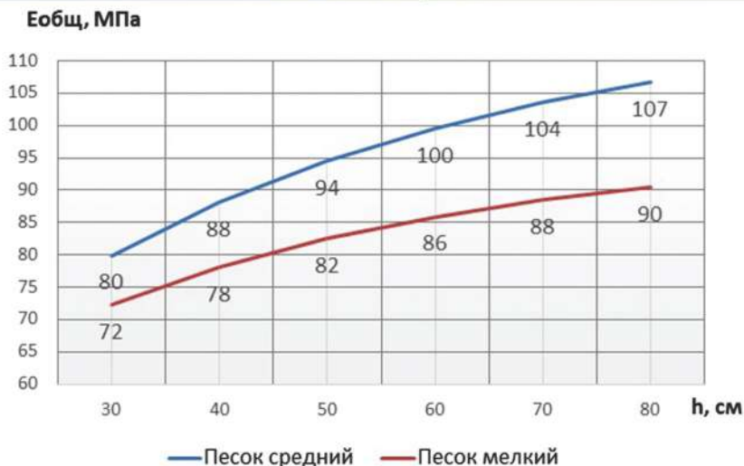
Рис. 2 Зависимость модуля упругости на поверхности морозозащитного слоя от его толщины.
