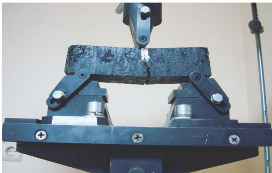
Рисунок 3 – Вид разрушения составного образца
