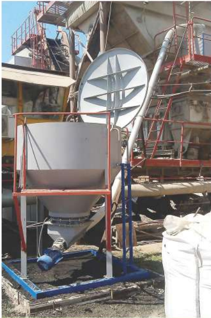
Рисунок 4 – Подача РБВ-Г по стандартной линии подачи целлюлозы
