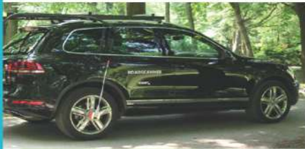
Фото 3. Установленная на машине система Roadscanner
