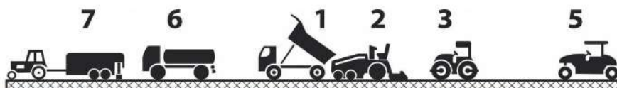
Рисунок 2 Схемы нагрева основания при устройстве покрытия: 1 – автомобиль-самосвал; 2 – асфальтоукладчик; 3 – каток гладковальцовый; 5 – каток на пневматических шинах; 6 – автогудронатор; 7 – Терморазогреватель РТО-001
