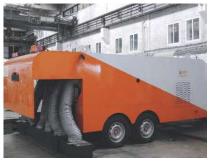
Рисунок 3 Общий вид Терморазогревателя РТО-001: справа – перед началом работы; слева – вид сзади в рабочем положении
