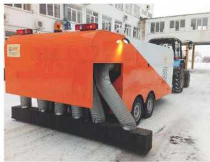
Рисунок 3 Общий вид Терморазогревателя РТО-001: справа – перед началом работы; слева – вид сзади в рабочем положении
