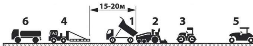
Рисунок 1 Схемы нагрева основания при устройстве покрытия: 1 – автомобиль-самосвал; 2 – асфальтоукладчик; 3 – каток гладковальцовый; 4 – терморазогреватель; 5 – каток на пневматических шинах; 6 – автогудронатор
