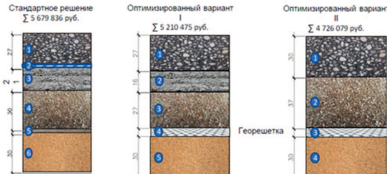
Рис. 8. Пример вариантного проектирования
